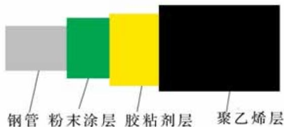
图三层防腐结构示意图
