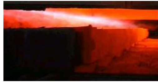
图 1 高炉煤气燃烧火焰
