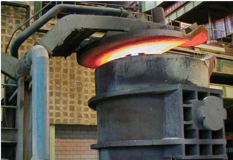
目前国内外钢铁企业普遍采用的钢包烘烤器主要分为两类：立式烘烤器和卧式烘烤器。存在的主要问题是：烘烤时间长、烘烤温度低、烘烤质量差、能耗高。
